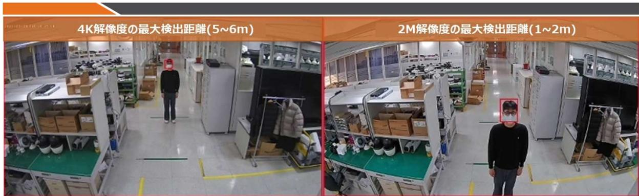
図 14. カメラ解像度別の最大検出距離動作の例
